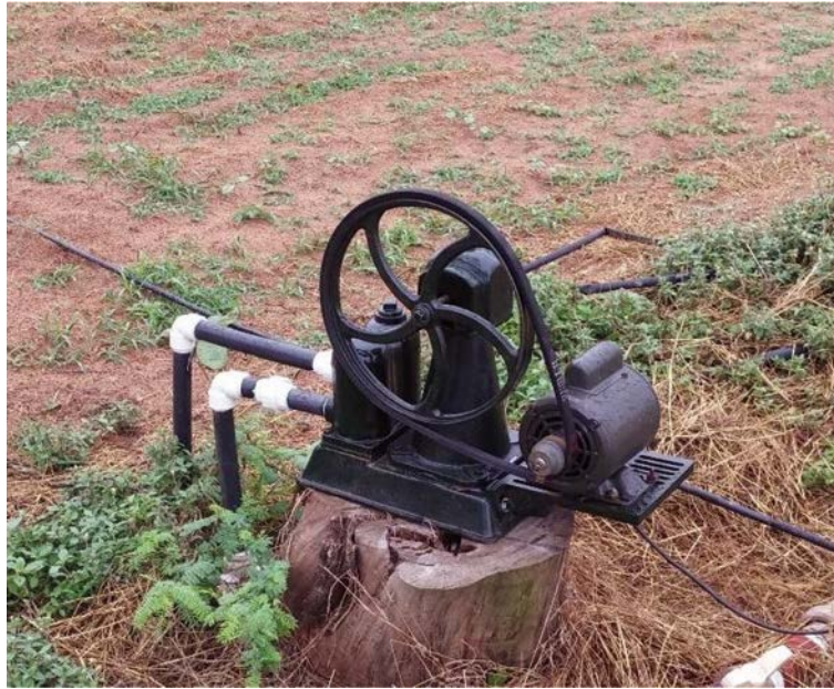
Fotografía 20. Pozo somero tipo bombilla con bomba de diafragma.
