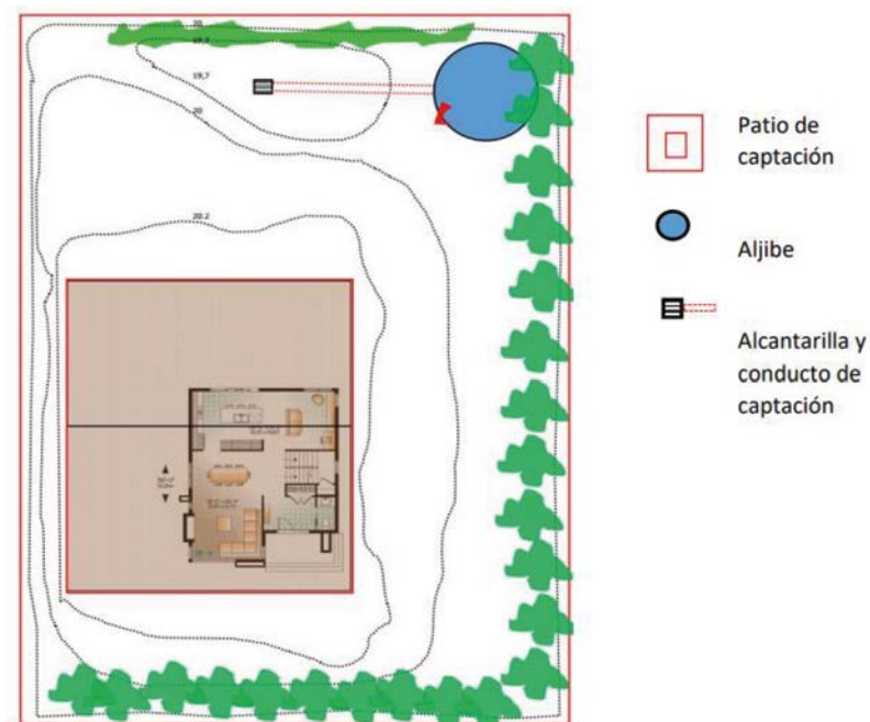
Imagen 2. Lámina esquemática de vivienda con áreas de patio sistematizadas para cosecha de agua.
